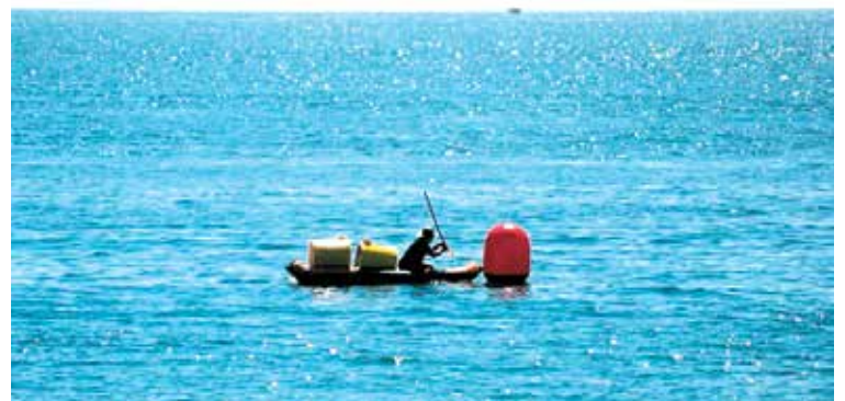
aquestes boies, té una capacitat de filtrat màxima diària de 270 metres cúbics, sent capaç de recollir fins a 216 partícules de microplàstic d'entre 0,5 i 4 mm cada dia.
